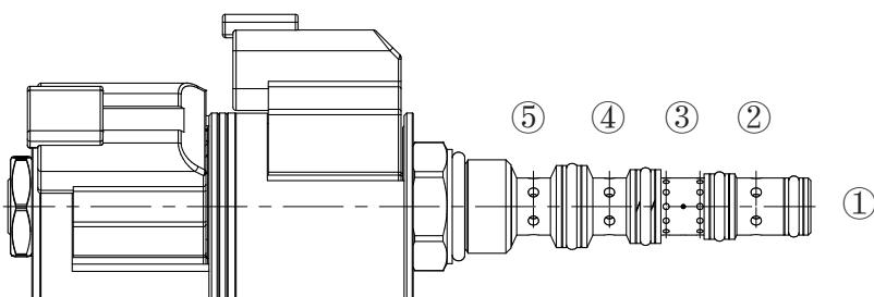
断电时, SV08-58C 工作油口之间全部被阻断, 只有负载敏感油口①接通油口③。线圈 S1 通电时, 允许油液从⑤流向②, 以及从④流向③。线圈 S2 通电时, 油液可以从⑤流向④, 以及从②流向③。阀芯换向之后负载敏感油口①始终连接到端口⑤。
