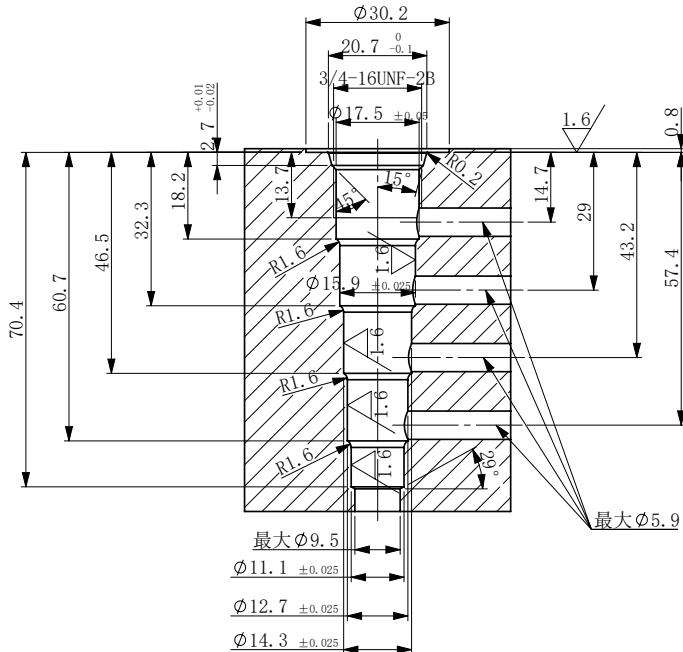
可以同时使用一种成型刀具加工上述阀孔
